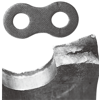
②피로 파괴 피로 한도를 초과하는 하중이 가해져서 구멍의 안쪽 면부터 피로가 발생하며 중간부터는 급격하게 파괴된다.
