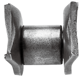
③옴셋 플레이트의 피로 옴셋 플레이트는 중앙에서 급힘 가공되어 있으므로 구부러진 부분의 응력 집중에 의해 피로 파괴를 일으킬 수 있다. 옴셋 연결구는 가능한 한 사용을 피한다.
